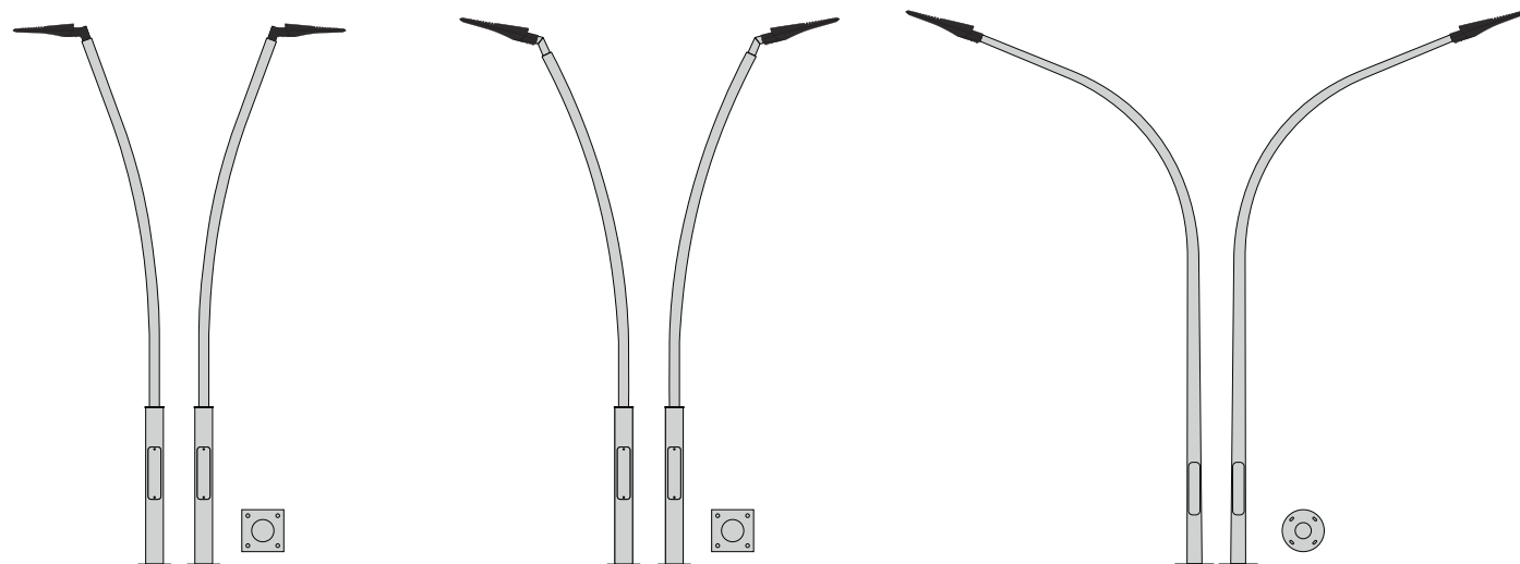
Несилловая Фланцевая Гнутая (декоративная опора)
