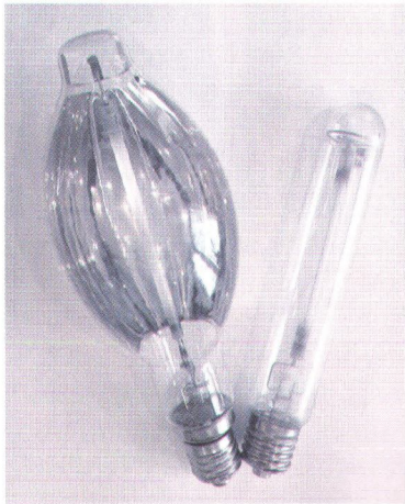
Фото 1. НЛВД 600Вт в стандартной и зеркальной колбе после 4-х лет эксплуатации.
