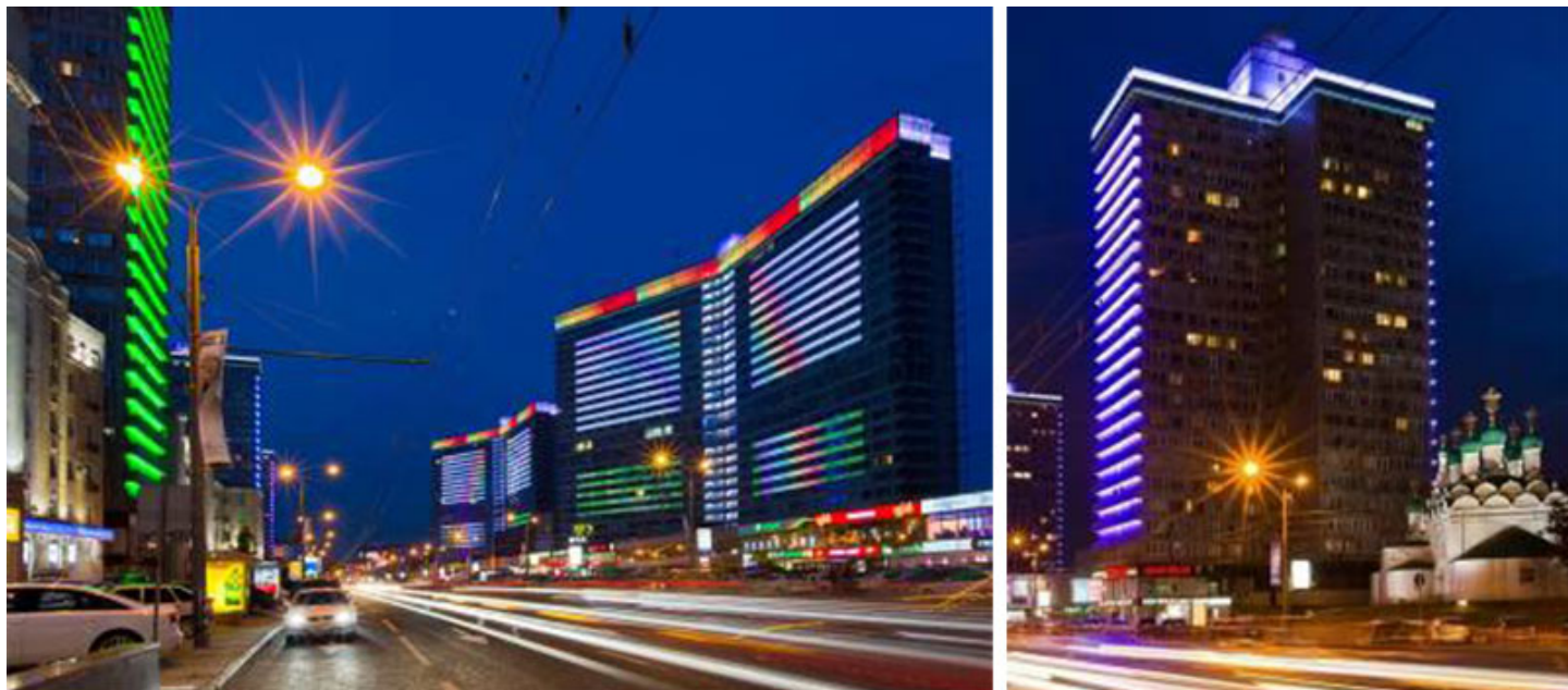
Рис. 2. Новый Арбат. Цветодинамическая подсветка. Для торцевой подсветки использованы светильники GALAD Аркус ДДУ74 с управлением по протоколу DMX.
