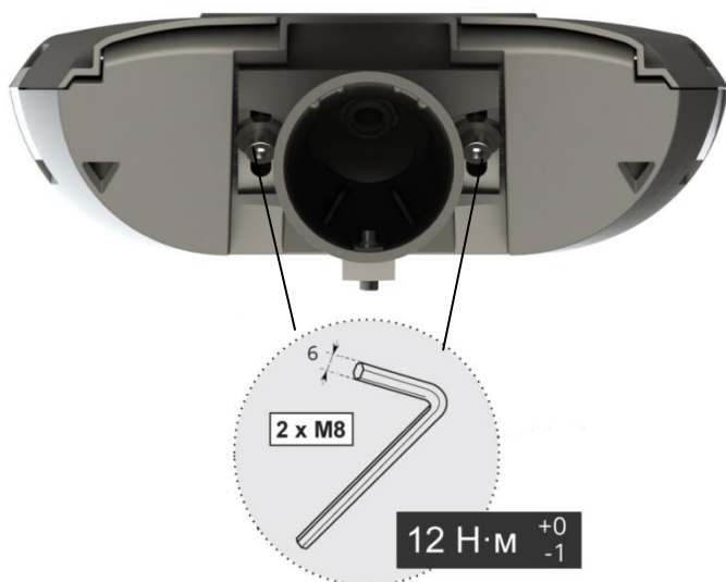
Рисунок 10.8 Светильник имеет возможность регулировки угла наклона \pm 20^\circ при монтаже на консоль (кронштейн) или на вертикальную опору. Для регулировки угла необходимо ослабить два винта M8.
