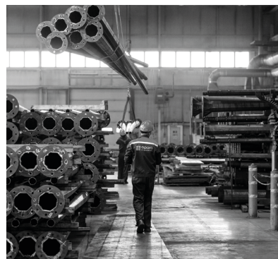
Производство металлоконструкций (мачты, опоры освещения, кронштейны и т.д.).
