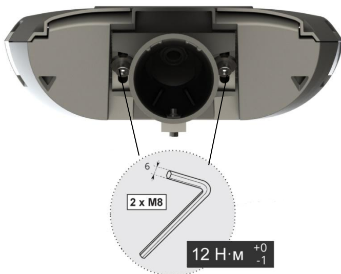
Рисунок 10.8 Светильник имеет возможность регулировки угла наклона \pm 20^\circ при монтаже на консоль (кронштейн) или на вертикальную опору. Для регулировки угла необходимо ослабить два винта М8.
