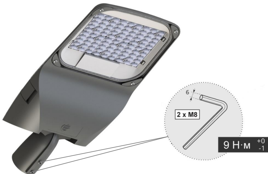
Рисунок 10.7 Выровняйте светильник по горизонтали и зафиксируйте его, закрутив два винта М8
